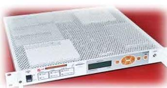
Перетворювач КРІОБ.434851.001 призначений для перетворення сигналу вхідного діапазону частот 50...90 МГц в діапазон частот 950...1750 МГц у складі передавальної апаратури станції супутниковою зв'язку діапазону 13,75...14,5 ГГц спільно з виносним перетворювачем частоти з L- діапазону в Ки- діапазон.
