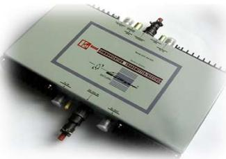
Блок приймання та передачі (БПП Ku) є винесним блоком перетворення частот в приймальному та передавальному трактах станції спутникового зв'язку Ku – діапазону.
